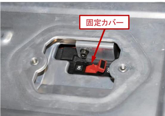
3. 固定カバーの向きを合わせて取り付け、メインスイッチをOFF位置に確実に固定する。
