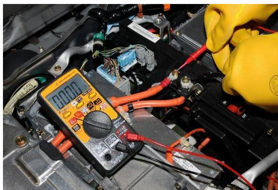
2. ジャンクションボードの高電圧端子間の電圧を、左図の位置で測定し、端子電圧が0Vであることを確認する。
