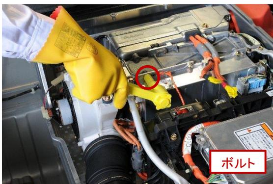
3. アースハーネス取り付けボルトを取り外す。取り外したアースハーネスも絶縁テープを巻き付け、絶縁処理をする。
