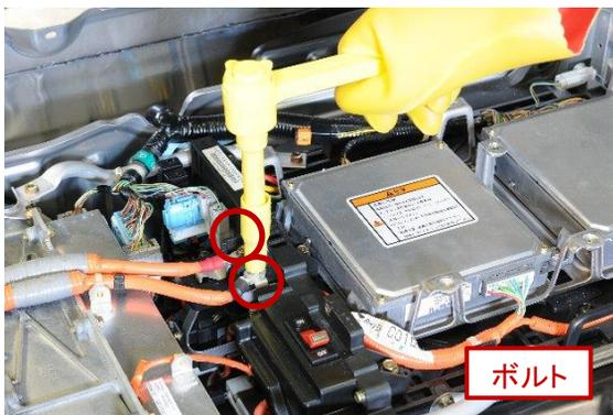
1. 高電圧ケーブル取り付けボルト(2本)を取り外す。
