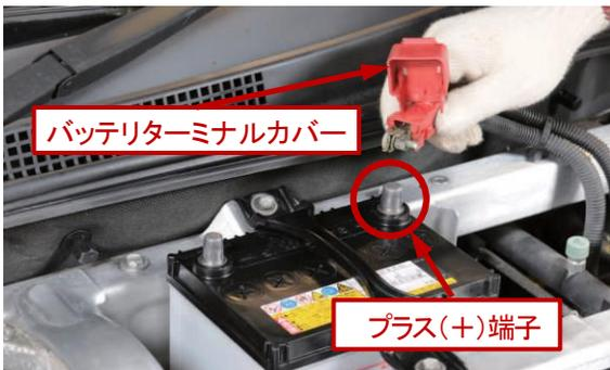
2. バッテリーターミナルのカバーを外して、プラス(+)'端子側のケーブルを外す。
