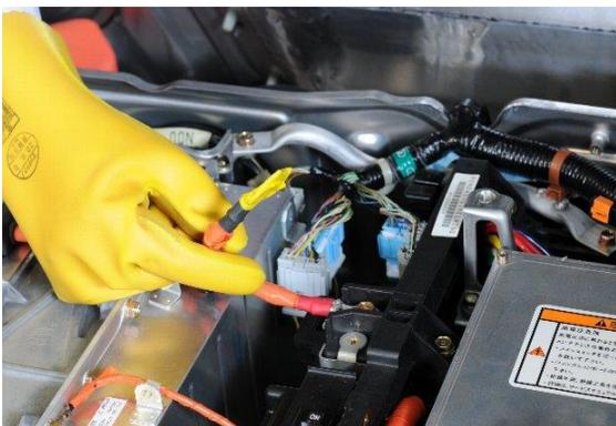
2. 取り外した高電圧ケーブルは、1本取り外すごとに絶縁テープを巻き付け、絶縁処理をする。
