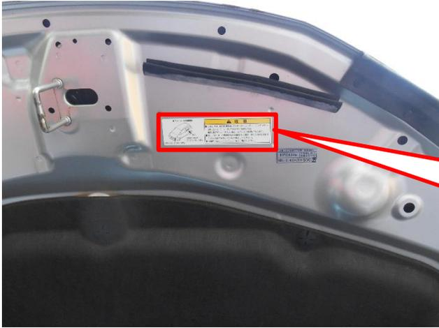
(1) ボンネット裏側の「EDLC MODULE」ラベルを確認する。
