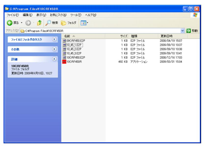
2010CRF450R PGM-FIセッティングツールのマニュアルの14ページのファイルロードの手順にしたがい、ECUに書き込みます。
