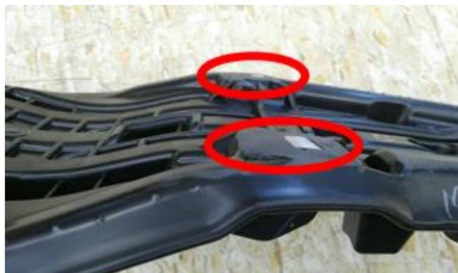
7-3-11-2 シート中央下部の底板に取り付けられている金属ステーを取り外す事が出来る。
