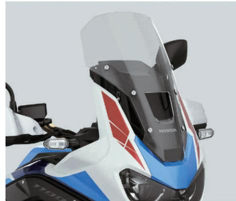
ライダーのポジションや体格に合わせて調整可能な5段階調整式ロングスクリーンは形状を変更し視認性を向上
