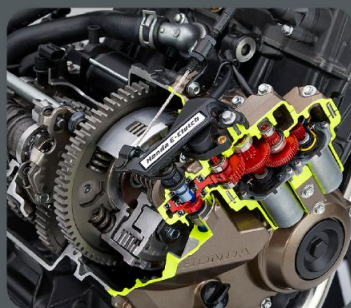
※Honda E-Clutchカットモデル
