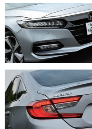
←ヘッドランプやフォグ&コーナリングランプはLED式。 ←テールランプはウインカー以外をLED式としている。
