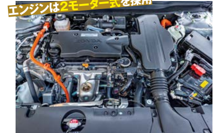
↑ホンダ自慢のVTECと電動VTCを採用した2.0Lエンジンと2モーターのハイブリッドシステムを採用。3.0V6エンジン並みのトルクを実現している
