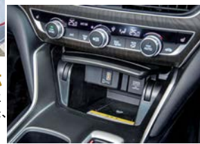
置くだけ充電にも対応 ↑ワイヤレス給電の国際規格「Qi」に準拠した充電器を装備している。また、上部にUSB充電器も備える
