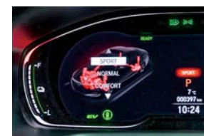
SPORTモードを搭載 ↑ダンパーの減衰力やハンドリングの制御なども変わり俊敏な動きを実現。エンジンサウンドコントロールも採用
