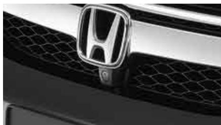
車両のフロントグリル部分に装着した広角カメラにより、見通しの悪い道路などで、車の先端を少し出すことで左右方向、前方の3方向を同時にナビ画面で確認できるシステム。
