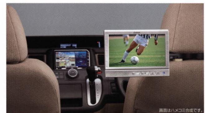
※ナビゲーションの地図表示およびフロント、コーナー、リアカメラ映像はご覧になれません。 ※リア席モニターの操作ボタンでは、ナビゲーションシステムの機能をコントロールすることはできません。 ※VTRを再生する場合は、ナビコンボへVTRコードを接続するか、リア席モニターへ直接AVコードを接続する必要があります。
