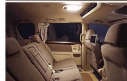
■従来の蛍光灯に変わり新光源の冷陰極管を採用することで、スリムなデザインと高速点灯を実現。2列目中央付近を照らすスポットライト、7色の中から色を変えられるLEDムーディーライトも装備しています。
