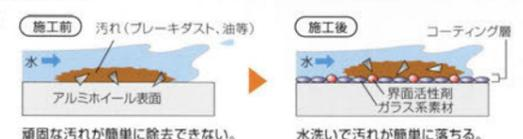
頑固な汚れが簡単に除去できない。 水洗いでの汚れが簡単に落ちる。
