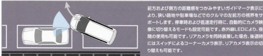
前方および側方の距離感をつかみやすいガイドマーク表示により、狭い路地や駐車場などでのクルマの左前方の視界をサポートします。停車時および低速走行時に、自動的にカメラ映像に切り替えるモードも設定可能です。赤外線LEDにより、夜間の使用も可能です。リアカメラを同時装着した場合、後退時にはスイッチによるコーナーカメラ表示、リアカメラ表示の切り替えも可能です。
