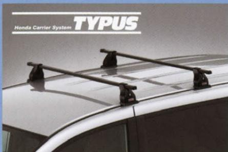
■各アタッチメントの装着ベース。フットセット+バーセット+ベースセットの組み合わせで、ベースキャリアになります。
