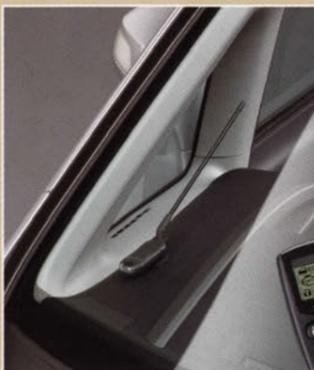
■離れた場所からリモコン操作でエンジンをスタート。エアコンをセットしておけば乗り込むときには車内が適温になっています。始動後、約10分でエンジンは自動停止します。
