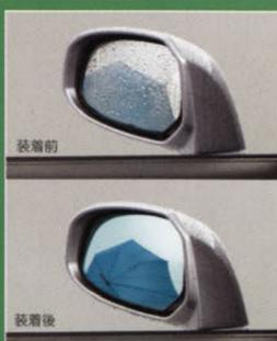
■表面に親水処理を施すことにより、雨滴を膜のように広げ、雨天時の視認性を向上させるミラーです。
