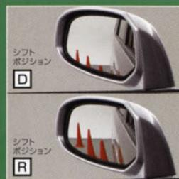
■セレクトレバーをDに入れると、左側のミラーが自動的に下向きになり、車庫入れなどのバック時に、見えにくい左後輪付近の視界を確保できます。
