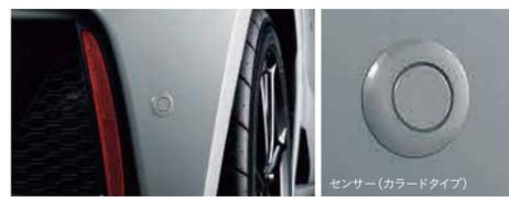
**05 コーナーセンサー** (超音波感知システム・2センサー/リア用左右セット) 全タイプ
