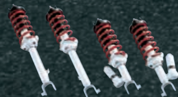
5段階式減衰力調整つまみ(フロントのみ) エンジンルーム内のダンパーマウント部にある調整つまみで、1(軽快な操舵感)から5(しっかりした操舵感)まで走行条件と好みに合わせてセレクトできる。
