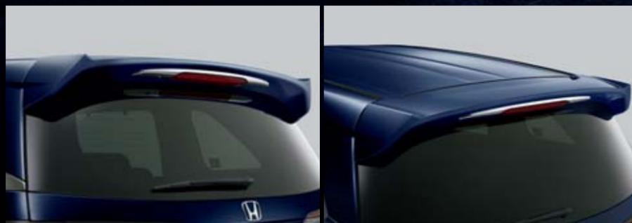
※標準装備のテールゲートスポイラーを取り外し装着となります。 ※ボディコート施工前に装着してください。
