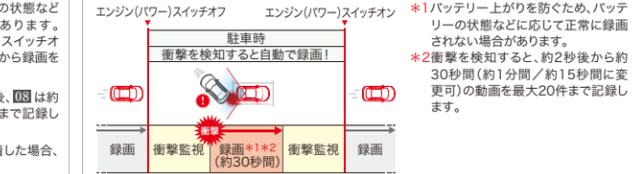
※1 バッテリー上がりを防ぐため、バッテリーの状態などに応じて正常に録画されない場合があります。DRH-204VDの場合、エンジン(パワー)スイッチオフの約30秒後(1分後/3分後に変更可能)から録画を開始します。 ※2 衝撃を検知すると、**[01]** **[05]** **[07]** は約4秒後、**[08]** は約5秒後から約60秒間の動画を最大10件まで記録します。 ※DRH-204VDと後方録画カメラを同時装着した場合、前方と後方の動画を同時に記録します。
