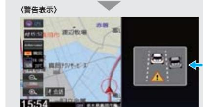
自車の車速が約30km/h以上で前進しているときに検知。ナビ画面にマーク表示に加え、警報音でも警告します。
