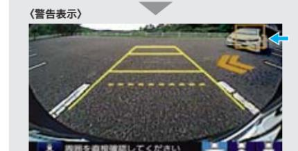
シフトポジションが[R]のときにシステムをONにしていると、車両後方の左右から接近する移動物を検知して画面表示と警報音でお知らせします。
