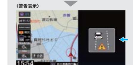
自車の車速が約60km/h以上で前進しているときに、方向指示器を操作せずに車線を逸脱しようになると作動します。
