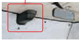
当て布を取り外してシティブレーキアクティブシステムのセンサー部に対応。
