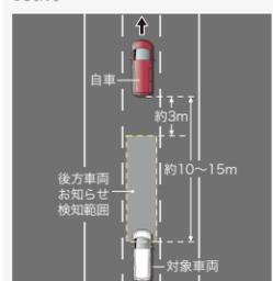
60km/h以上(初期設定値)で走行中、後方車両お知らせ検知範囲に一定時間(約2秒)留まっている車両を検知すると、アイコンが緑色から黄色に変わります。(後方車両が検知範囲から離れたら、黄色に戻ります。)さらに橙色の状態が一定時間(約3〜5秒)続く、音声でお知らせします。
