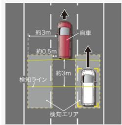
自車の車速が約30km/h以上で前進しているときに検知。ナビ画面にマーク表示に加え、音でも警告します。
