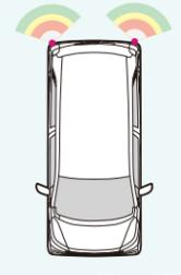
※センサーと障害物との距離が約20cm以下、または障害物の種類や状況により感知しない場合があります。※コーナーセンサーは障害物等の確認のための補助手段として使用してください。安全のためコーナーセンサー使用時も直接目視で周辺の安全確認を行いながら運転してください。※雨漏、雪、泥などがセンサー部に付着した場合や、使用状況により正常に作動しない場合があります。
