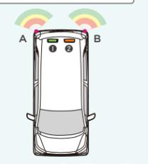
※センサーと障害物との距離が約20cm以下、または障害物の種類や状況により反応しない場合があります。※センサーインジケーターは障害物等の確認のための補助手段として使用してください。安全のためコーナーセンサー使用時も直接目視で周辺の安全確認を行いながら運転してください。※雨漏、雪、泥などがセンサー部に付着した場合や、使用状況により正常に作動しない場合があります。
