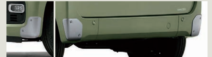
※デカール、バンパーコーナーガーニッシュは、ボディコート施工前に装着してください。
