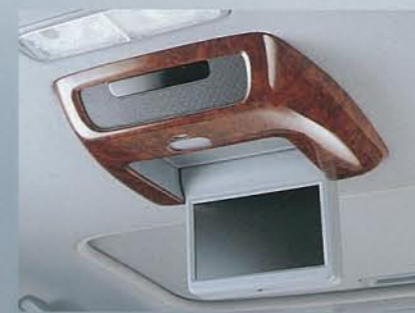
2 Honda-インテグレートドモニターシステム部パネル装着例
