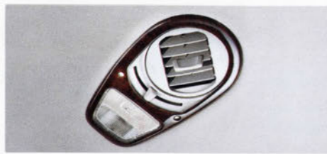
D 独立コントロール エアコンアウトレット部×4点
