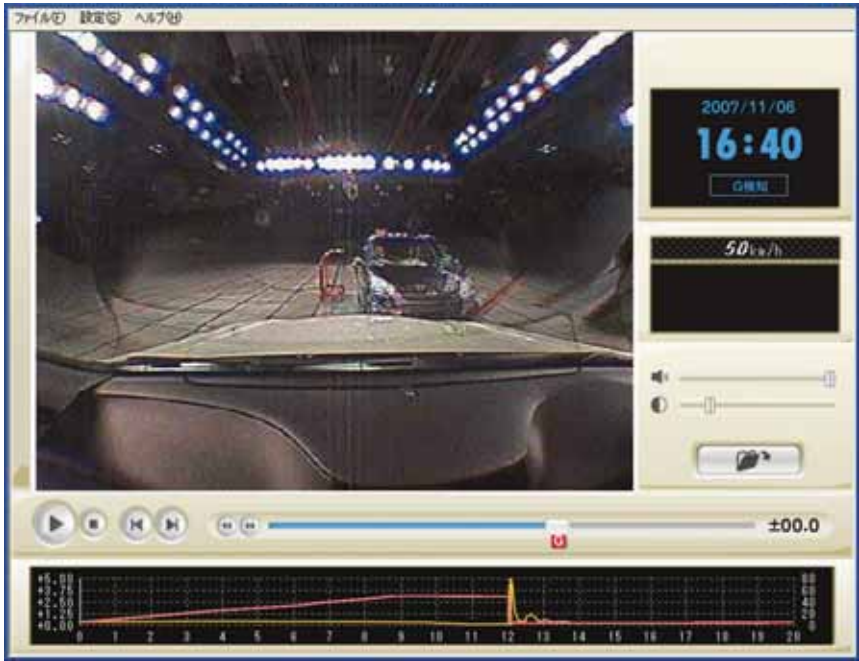
パソコンでの画面表示例：映像、音声、日時、速度、加速度と速度を時系列で表示するグラフなど、映像保存時の情報を表示します。 ※掲載写真は衝突実験時のものです。実際の映像は外部環境により映像画質が変化します。
