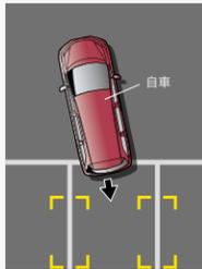
シフトポジションが[R]で自車の車速が約5km/h以下で、ダブルビュー画面に切り替えると作動します。
