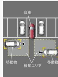
シフトポジションが[R]のときにシステムをONにしていて、車両後方の左右から接近する移動物を検知して画面表示および音でお知らせします。
