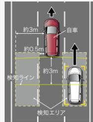
自車の車速が約30km/h以上で前進しているときに、方向指示器を操作せずにナビ画面上マーク表示に加え、音でも警告します。
