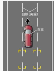
自車の車速が約60km/h以上で前進しているときに、方向指示器を操作せずに車線を逸脱しようになると作動します。
