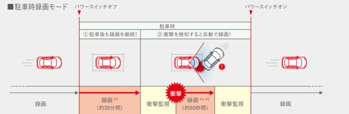
\*1 バッテリー上がりを防ぐため、バッテリーの状態などに応じて正常に録画されない場合があります。DRH-204VDの場合、パワースイッチオフの約30秒後(1分後/3分後に変更可)から録画を開始します。
