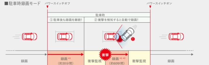
\*1 バッテリー上がりを防ぐため、バッテリーの状態などに応じて正常に録画されない場合があります。DRH-204VDの場合、パワースイッチオフの約30秒後(1分後/3分後に変更可)から録画を開始します。
