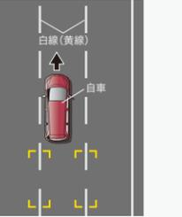
自車の車速が約60km/h以上で前進しているときに、方向指示器を操作せずに車線を逸脱しようになると作動します。
