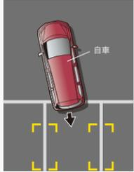
シフトポジションが[R]で自車の車速が約5km/h以下のとき、ダブルビュー画面に切り替えると作動します。
