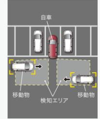
シフトポジションが[R]のときにシステムをONにしていると、車両後方の左右から接近する移動物を検知して画面表示および音でお知らせします。
