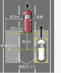
自車の車速が約30km/h以上で前進しているときに検知。ナビ画面上マーク表示に加え、音でも警告します。
