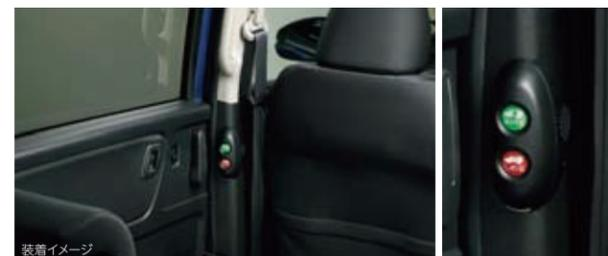
ボタン操作で助手席側パワースライドドアの開け閉めができ、設定したメロディが流れます。お子様の喜ぶメロディ5曲に加え1曲録音・再生が可能です。また、開け閉め時にはダウンライトが点灯し足元をやさしく照らします。
