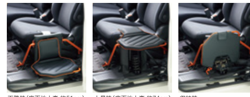
下降時(座面地上高:約51cm) 上昇時(座面地上高:約74cm) 収納時(シート寸法:長約35cm×幅約30cm)
