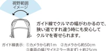
ガイド線表示：①カメラから約1m ②カメラから約50cm ③車両の幅(サイドミラー含まず) + 約25cm
