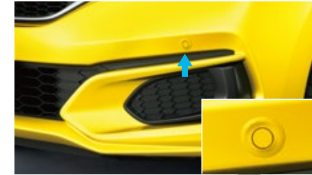
フロントコーナーセンサー位置 ※写真は [H-F] の装着例です。
