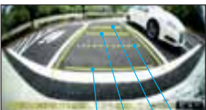
ガイド線表示 車両後端より: 約0.5m・約2m・約3m テールゲート開閉可能位置目安
