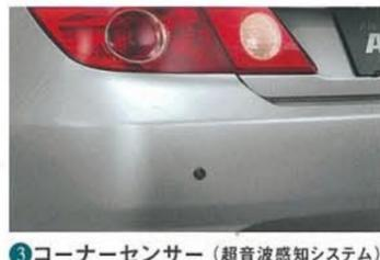
**3 コーナーセンサー (超音波感知システム) リア用 左右セット**
