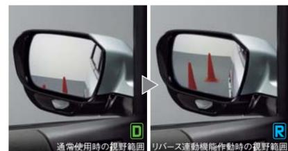
セレクトレバーをRに入れたら、左側のミラーが自動的に下向きになり、車庫入れなどのバック時に見えにくい左後輪付近の視界をサポートします。
