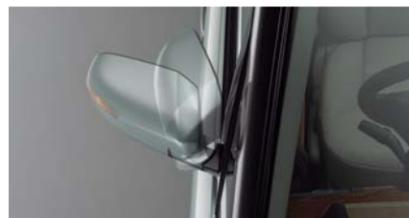
ドアのロック・アンロックに連動します。ロックで格納・アンロックで展開します。運転席の格納スイッチでドリアミラーを格納した場合、ドリアミラーが展開しない格納スイッチ優先機能付です。
