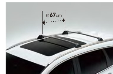
*2 ルーフレール装備車/装着車に装着できます。 許容重量:75kg
