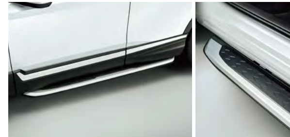
許容重量:100kg ※サイドドアアガーニッシュとの同時装着はできません。
