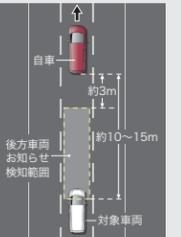
**60km/h以上(初期設定値)で走行中、後方車両お知らせ検知範囲に一定時間(約2秒)留まっている車両を検知すると、アイコンが緑色から橙色に変わります。(後方車両が検知範囲から離れたとき、緑色に戻ります。)さらに橙色の状態が一定時間(約3~5秒)続く、と音でお知らせします。**
