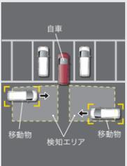
**シフトポジションが[R]のときにシステムをONにしていると、車両後方の左右から接近する移動物を検出して画面表示および音でお知らせします。**
