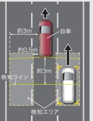
**自車の車速が約30km/h以上で前進しているときに検知。ナビ画面上マーク表示に加え、音でも警告します。**
