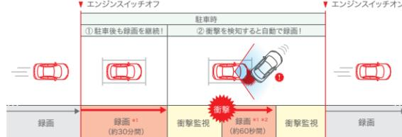
\*1 バッテリー上がりを防ぐため、バッテリーの状態などに応じて正常に録画されない場合があります。DRH-204VDの場合、エンジンスイッチオフの約30秒後(1分後/3分後に変更可)から録画を開始します。
