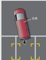
**シフトポジションが[R]で自車の車速が約5km/h以下のとき、ダブルビュー画面に切り替わりと作動します。**
