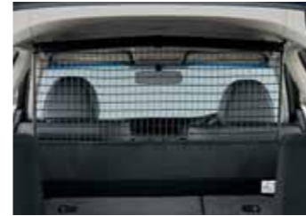
04. セパレーションネット TL TLU キャビンとラゲッジルームの境目を仕切るネット。リアシートを倒しても使用可能。 ¥31,500 (消費税抜き¥30,000) [0.2H] 08U35-TL6-010 ※ドッグガード、カーゴスペースディバイダーとの同時装着はできません。
