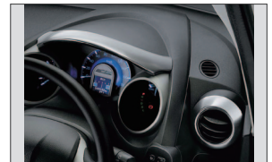
インテリアパネル メーターバイザー/アウトレットリング
