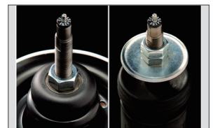
スポーツサスペンション (前後5段階減衰力調整機構)
