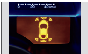
センサー マルチインフォメーション ディスプレイ表示 (説明のため全方位表示)
