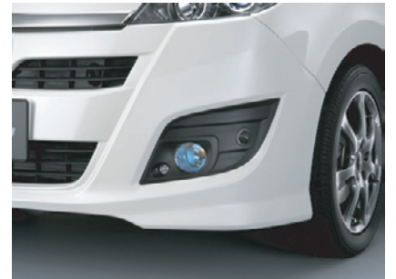
ハロゲンフォグライト(マルチコートブルー)、 ビームライト、コーナーカメラ (Moduloフロントバンパー装着車)
