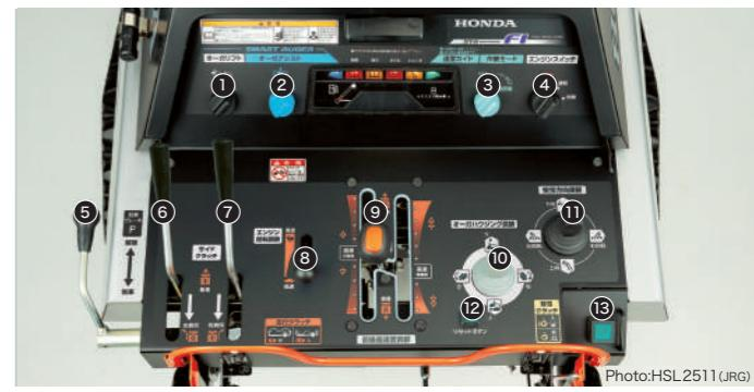
①オーガリフトスイッチ ②オーガアシストスイッチ ③除雪作業モード切替スイッチ ④エンジンスイッチ ⑤駐車ブレーキレバー
