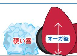
しまり雪の処理では雪を破碎できるオーガの径が高さの目安。
