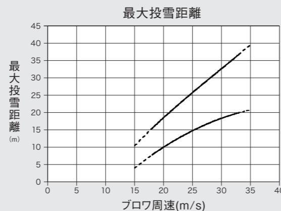
\*グラフは目安です。雪質など使用条件により最大除雪量、最大投雪距離は異なります。グラフは除雪機安全協議会会員の2017年モデルのデータを基に作成しています。
