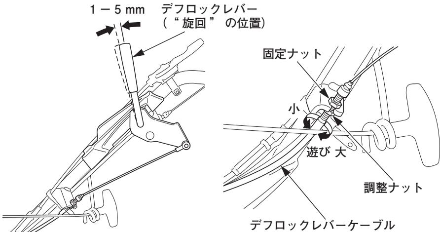
3. 調整後、固定ナットを確実に締付けてください。
