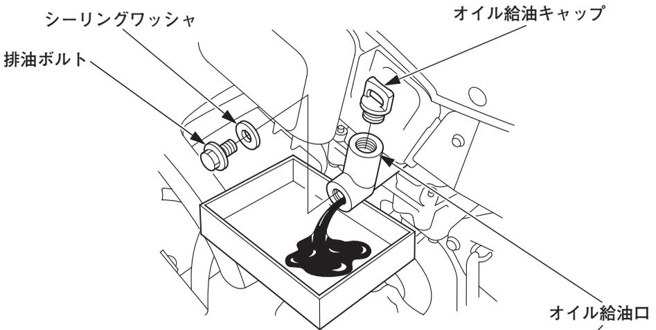
5. 平坦な場所で本機を耕うん爪 (ロータリ) と後車輪が接地した状態にして新しいエンジンオイルを給油口のレベル位置で確認しながら上限まで注入します。
