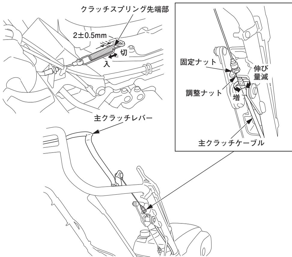
2. 調整後、固定ナットを確実に締付けてください。
