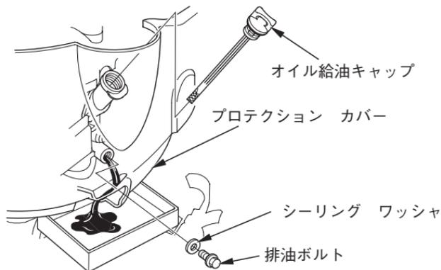
4. 新しいシーリング ワッシャを取付け、排油ボルトを確実に締付けます。
