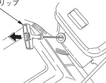
2. 燃料タンク、キャブレタ(気化器)の燃料を抜きます。
