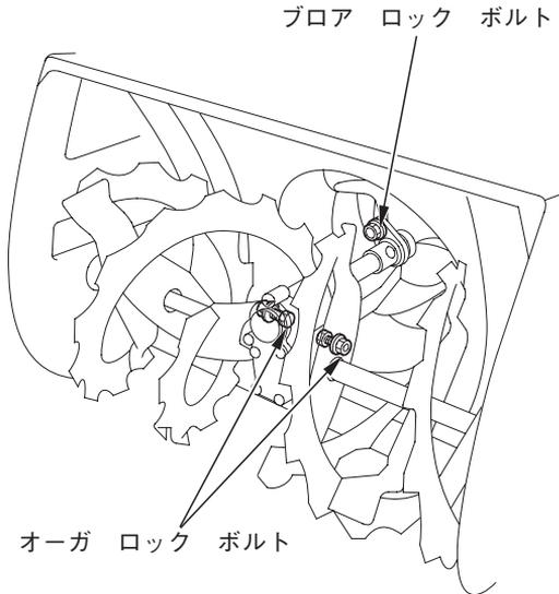
☆オーガ、ブローアのロック ボルトは、石のかみ込みなどの異常な負荷が加わった際に、本機の損傷を防ぐために折れるしくみになっています。
