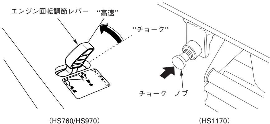
8. エンジン回転が安定するのを確認しながらエンジン回転調節レバーを“低速”の位置に戻し、暖機運転を行ってください。
