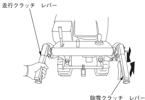
☆除雪の時は、除雪クラッチ レバーを先に操作してください。
