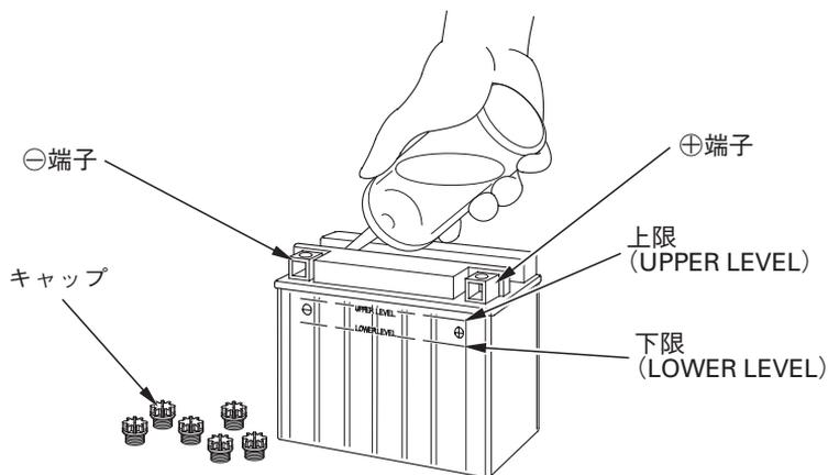
☆端子のゆるみ、腐食は接触不良の原因となります。ゆるんでいるときは確実に締付けてください。
