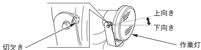
☆調節後は必ずボルトを確実に締付けてください。
