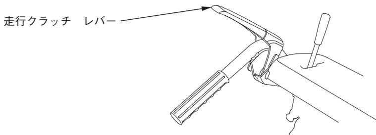
除雪クラッチ レバーと走行クラッチ レバーを連動して作動させることができます。(47 頁参照)
