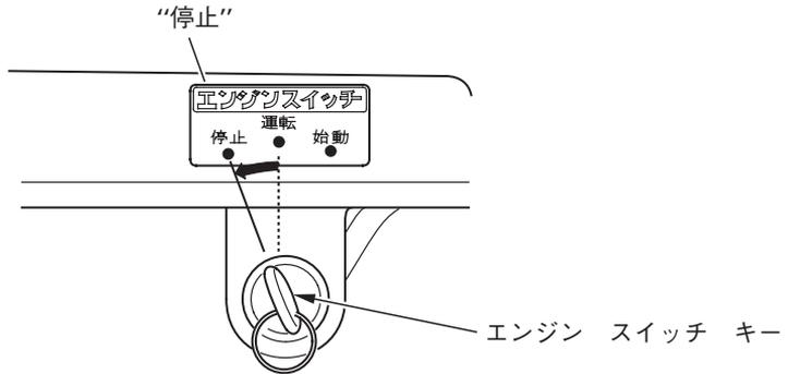
☆エンジン スイッチ キーを使って本機を緊急停止させた場合は再び始動する前に変速レバーを“N”(中立)の位置にしてください。
