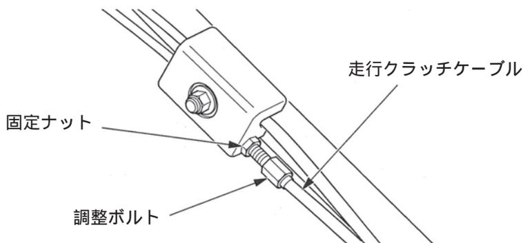
3. 固定ナットを確実に締付けます。
