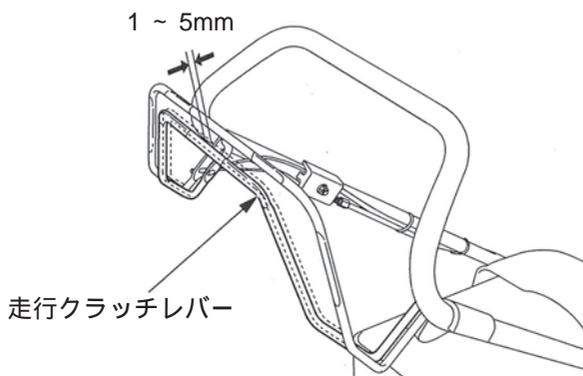
2. 調整は固定ナットをゆるめ、調整ボルトをまわして行います。
