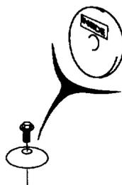
4. Maintenez fermement la lame et utilisez une clé dynamométrique pour vérifier que la vis de lame est correctement serrée.
