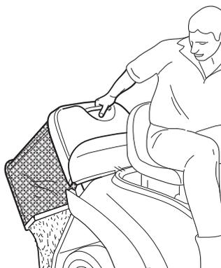
**REMARQUE** *Après avoir vidé le bac de ramassage, il peut arriver que le bip sonore se déclenche à nouveau au moment de l'embrayage de la lame et ce à cause de brins d'herbe restés sur le système de détection; dans ce cas, il suffit, pour interrompre le bip, d'enlever les brins d'herbe ou de débrayer et de rembrayer immédiatement la lame.*
