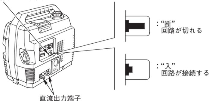
直流出力端子は直流出力を取出すところで、12Vバッテリーの充電専用です。交流出力を使用している場合でも直流出力を取出すことができます。充電コード(別売部品)のプラス、マイナスは極性に注意し、接触不良のないように確実に接続してください。充電コードの接続のしかたは29頁を参照してください。
