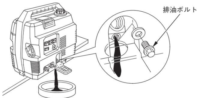
3. 排油ボルトを確実に締付けて、新しいエンジン オイルを注入口の口元まで注入します。
