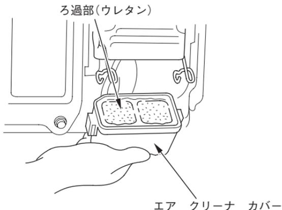
3. ろ過部(ウレタン)を洗い油で洗浄し、固くしぼってからエンジン オイル(ウルトラU汎用-SAE10W-30等)に浸し、固くしぼります。
