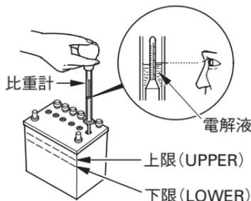
●必ず蒸留水を補給してください。水道水はバッテリーの寿命を縮める原因となります。
