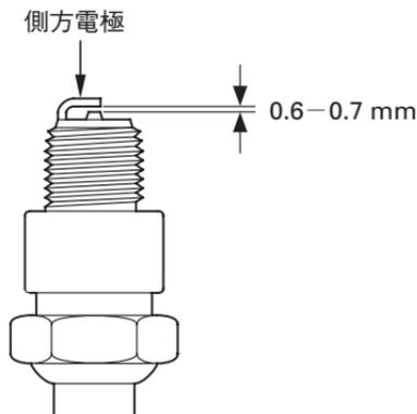
6. 取付けはまず手でねじ込み、次にプラグ レンチで確実に締付けます。
