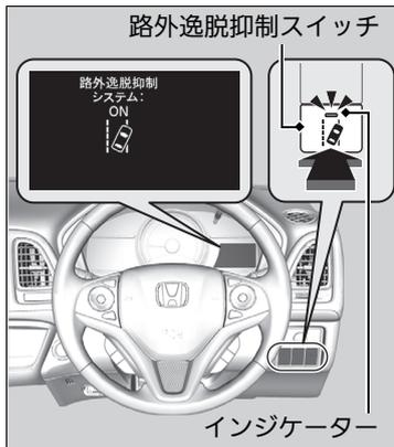
路外逸脱抑制スイッチを押して、システムの ON と OFF を切り替えてください。
