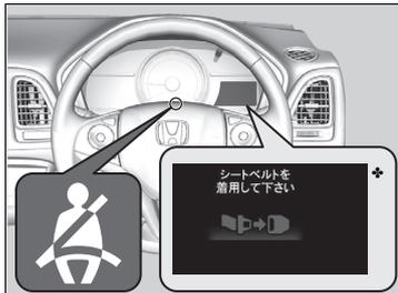
パワーモードをONモードにしたときや、走行したとき、運転席および助手席のシートベルトを着用するまでシートベルトリマインダーが作動し、ブザーと警告灯でお知らせします。
