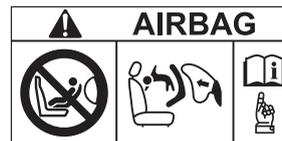
**シート前方の作動可能なエアバッグで保護されたシートには、後ろ向きチャイルドシートを絶対に取り付けしないでください。**
