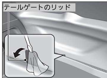
1. テールゲートのリッドに、マイナスドライバーの先端を差し込み、取り外す。
