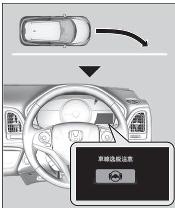
このシステムは、フロントガラス上部に設置されたカメラによって左右の白線または黄色線を検知し、方向指示器(ウィンカー)を使用せずに白線(黄線)を逸脱したことを判断したとき、作動します。
