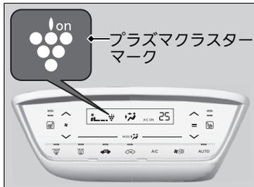
エアコンもしくは送風に連動してプラズマクラスターも作動し、マークが点灯します。
