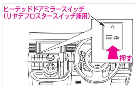
エンジンスイッチが“II”のとき、スイッチを押すと“ON”になり、同時に作動表示灯が点灯します。もう一度スイッチを押すと“OFF”になり、作動表示灯は消灯します。
