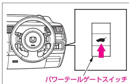
開閉中に“
