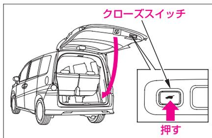
開閉中にクローズスイッチを押すと“ピーピーピー”とブザーが鳴り、パワーテールゲートが反対側に動きます。
