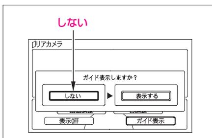
もう一度ガイド線を表示するときは、①～④の操作を繰り返し、ジョイスティックを右側に倒して「表示する」を選び、ジョイスティックを押します。
