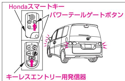
開閉中にパワーテールゲートボタンを押すと“ピーピーピー”とブザーが鳴り、パワーテールゲートが反対側に動きます。
