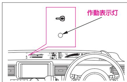
セッ트를解除するときは、キー、キーレスエントリーあるいはHondaスマートキーで解錠します。作動表示灯が消灯し、セッ트가解除されたことを知らせます。
