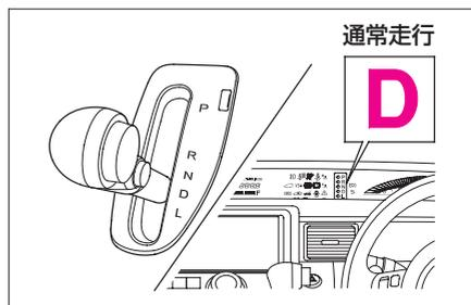
セレクトレバーをDにして走行します。アクセルペダルの踏み加減と走行速度により、低速から高速まで自動的に変速されます。
