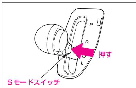
Sモードにすると高回転領域を有効に使用できます。同時に、メーター内のSモード表示灯が点灯します。
