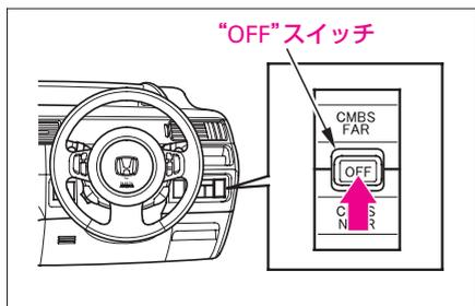
CMBSを使用するときは、再度OFFスイッチを約1秒以上押します。CMBSを“ON”にするとCMBS警告灯が消灯し、メーター内のディスプレイに“CMBS FAR”または“CMBS NEAR”が表示されます。このときブザー(ピー)も同時に鳴ります。
