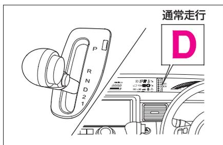
セレクタレバーを回にして走行します。アクセルペダルの踏み加減と走行速度により、1速から5速(5速オートマチック車)または1速から4速(4速オートマチック車)まで自動的に変速されます。
