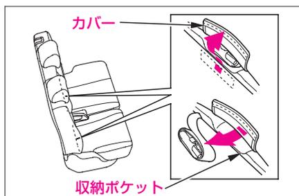
シートベルトを使わないときや、シートを前向きにしたときは、収納ポケットに戻し、カバーをシートクッションと背もたれの間にしめます。
