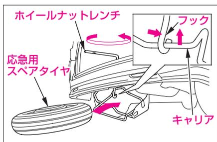
③ ゆるみ、ガタがないように固定ボルトを十分に締めつけます。
