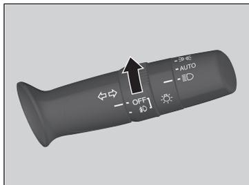
ライトスイッチが OFF 以外のとき(ライトスイッチを **AUTO** にしているときは、車幅灯やヘッドライトが点灯しているとき)に、フォグライトスイッチを回して点灯することができます。
