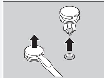
クリップを取り付けるときは、クリップ中央部のピンを起こしたまま差し込み、ピンを平らになるまで押してください。
