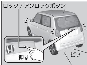
Honda スマートキーを携帯し、ロック / アンロックボタンを操作することでドア、テールゲートの施錠や解錠を操作します。ドア、テールゲートの施錠 / 解錠が作動するのは、運転席ドアハンドル、助手席ドアハンドル、テールゲートハンドルから周囲約80cm 以内です。
