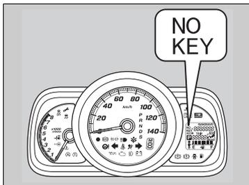
警告ブザーには、車内警告ブザー(ピーッピーッピーッピーッ)と車外警告ブザー(ピピピピピピ)の2種類があります。警告状態が続くときは、Honda スマートキーの携帯位置を変更してください。
