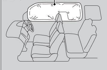
サイドカーテンエアバッグが作動するのは、一定以上の衝撃で側面方向から衝突したときです。運転席側または助手席側のサイドカーテンエアバッグが膨らみます。
