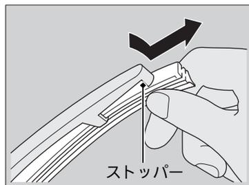
1. ラバーの先端部をブレードのストッパーから外れるまで引き、そのままラバーをブレードから引き抜く。
