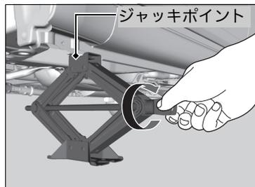
6. ジャッキの上部がジャッキポイントに接触するまで図の部分を実印の方向に回す。
