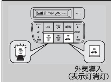
**FRONT** を押すとエアコンが作動し、自動的に外気導入に切り換わります。
