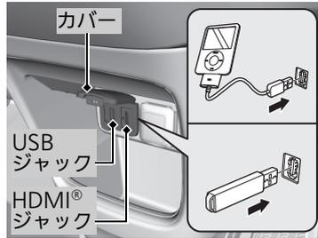
カバーを開け、iPod や iPhone の Dock コネクターや USB デバイス、スマートフォンの USB 接続コードを USB ジャックに接続します。また、HDMI® 接続コードを HDMI® ジャックに接続します。
