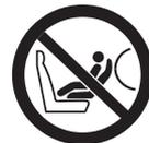
シート前部のエアバッグで保護されたシートには、後向きの幼児拘束装置を使わないでください。
