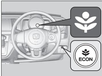
アイドリングストップシステムをOFFにするには、ECON スイッチを押してください。ECON 表示灯が消灯し、システムが OFF になります。
