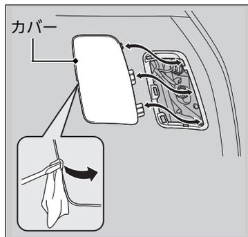
1. カバーの切り欠き部にマイナスドライバーの先端を差し込み、カバーを取り外す。
