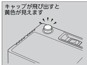
4. エアコンプレッサーのスイッチをONにして、キャップの飛び出しを確認する。
