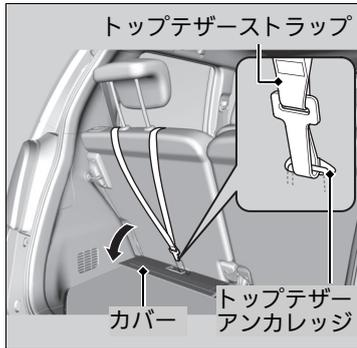
4. ヘッドレストを調節して最上段で固定し、トップテザーストラップをヘッドレストの下側に通す。
