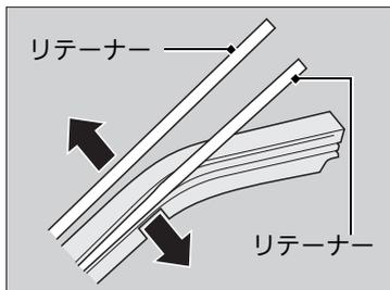
2. 引き抜いたラバーからリテーナーを外し、新しいラバーに取り付ける。
