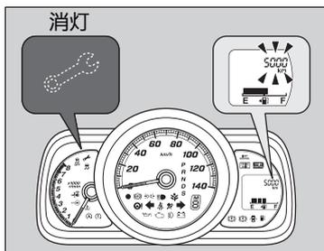
4. そのままセレクト / リセットノブを、エンジンオイルメンテナンス表示灯が点滅に切り換わるまで押し続ける。
