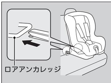
3. チャイルドシートを座席に置き、チャイルドシートの取扱説明書にしたがってロアアンカレッジに取り付ける。
