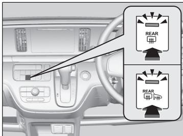
パワーモードがONモードのときに、リヤガラスとドアミラーを暖め、曇りをとりたいときに使用します。
