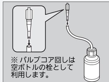
注入後の空ボトルは、タイヤ修理時に使用済み応急修理剤の回収に使用します。
