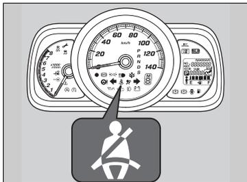
パワーモードをONモードにしたときや走行したとき、運転席または助手席のシートベルトを着用するまでシートベルトリマインダーが作動し、ブザーと警告灯でお知らせします。
