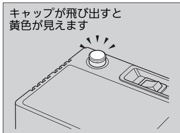
6. エアコンプレッサーのキャップの飛び出しを確認する。
