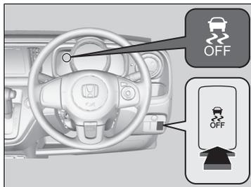
VSA を停止(OFF)状態にするには、
