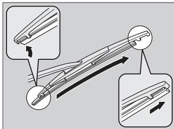
4. ブレードの先端のツメにラバーを通す。
