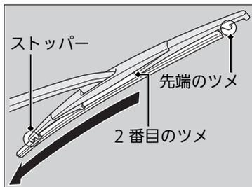
3. ラバーをブレードの 2 番目のツメからブレードに沿って差し込み、ラバーをブレードのストッパーから約 2cm 引き出す。
