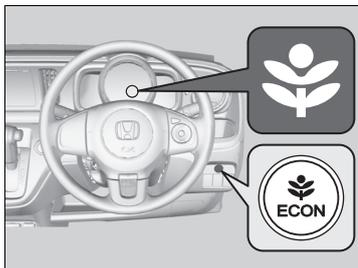
エンジン、トランスミッション、オートエアコン、クルーズコントロールの作動を制御して、省エネ運転をしやすいように制御します。
