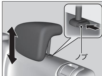
乗車するときは、走行する前にヘッドレストを引き上げて、確実に固定します。
