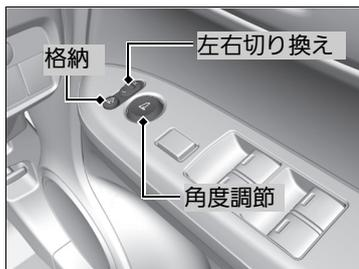
ドアミラーの操作は、パワーモードが ON モードのときに行います。
