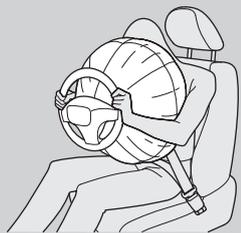
前方向から衝突すると、シートベルトが乗員の下半身と胴体を拘束し、SRSエアバッグが頭と胸部を保護します。
