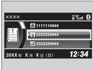
携帯電話をペアリングすると、携帯電話に登録されている電話帳と発信着信履歴のデータが自動で転送されます。
