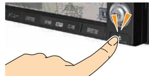
パネルが開き自動的にディスクを排出します。ディスクを抜いてください。ディスクを抜かず、しばらくするとディスクが自動で挿入され、パネルが閉まります。
