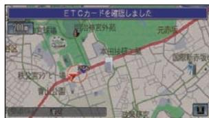
ETC カードの読み込みが正常に完了すれば、ETC 車載器の LED ランプが緑になり、画面にメッセージが表示されます。エラーメッセージが表示されたときは「[エラーメッセージと対処方法](#)」(P442) を参照してください。
