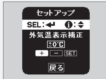
表示されている補正温度（工場出荷時は ±0℃）より高めに設定したい場合は、**i** インフォメーションスイッチで「+」を選択し、**SEL/RESET** スイッチを押して1℃ずつ補正温度を上げます。希望の温度になったら **i** インフォメーションスイッチで「SET」を選択し、**SEL/RESET** スイッチを押して設定を完了します。
