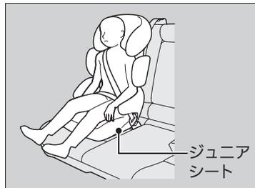
三点式シートベルトを使用できず、ジュニアシートを用いる必要があるお子さまは、ジュニアシートをリヤシートに設置して使用してください。安全のため、お子さまがジュニアシートの使用に適した範囲に入っているか確認してください。
