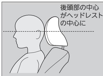
後頭部の中心が、ヘッドレストの中心に来るようにヘッドレストの高さを調節します。
